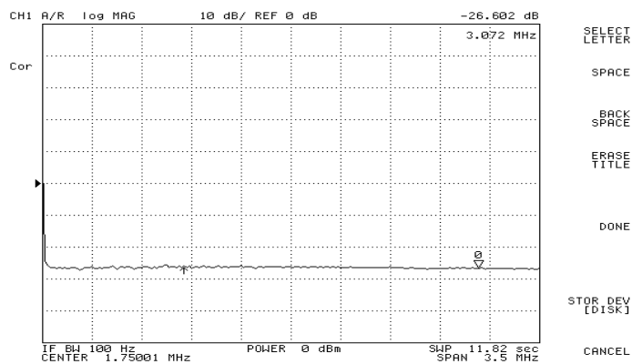
Figure-26 E1 120 Ω Transmit Return Loss
