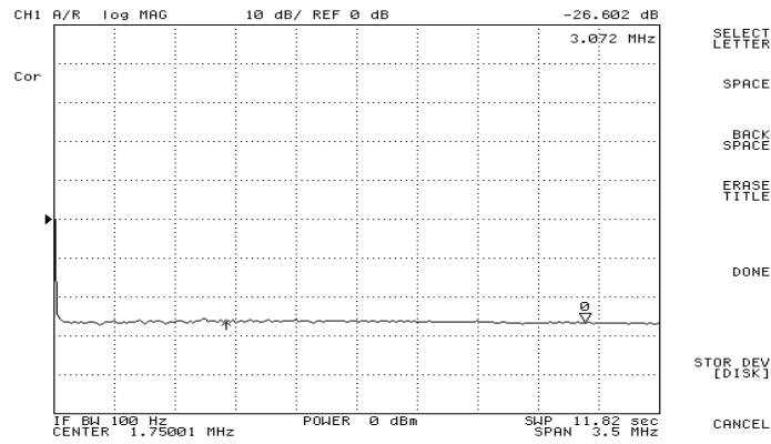
Figure-26 E1 120 Ω Transmit Return Loss
